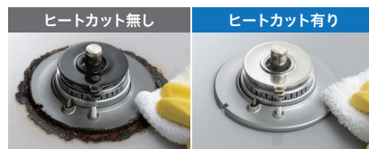
ヒートカット有無での加熱試験比較(いずれもガラストップ)
