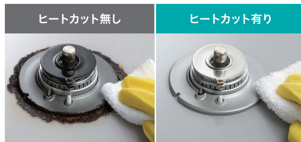
ヒートカット有無での加熱試験比較(いずれもガラストップ)
