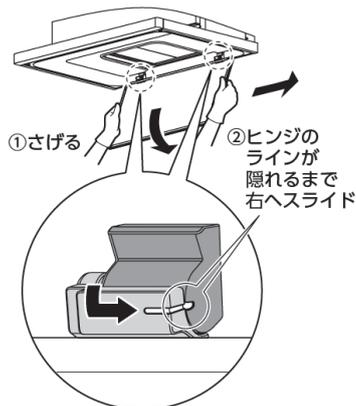
4 整流板を両手でしっかり持ち、軽く力を加えて、ハンガーとヒンジが、左右ともはずれないことを確認する
