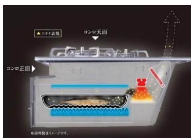
「アフターバーナー」と「触媒フィルター」で 煙とニオイを大幅カット
