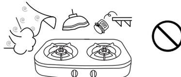
**周囲に可燃物**（木製などの可燃性の壁、ステンレス板や薄いタイルなどの不燃材を可燃性の壁に直接貼り付けた壁、たななど）**のある場合**
